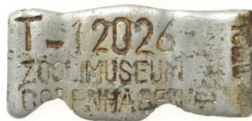
Eksempler på slidtage: En stålring (øverst) og en aluminiumsring (nederst) som har siddet på samme rødben i 5½ år. Example of ring wear: Steel ring (above) and aluminium ring (below) worn by the same Redshank for 5½ years. Foto: Geert Brovad.
